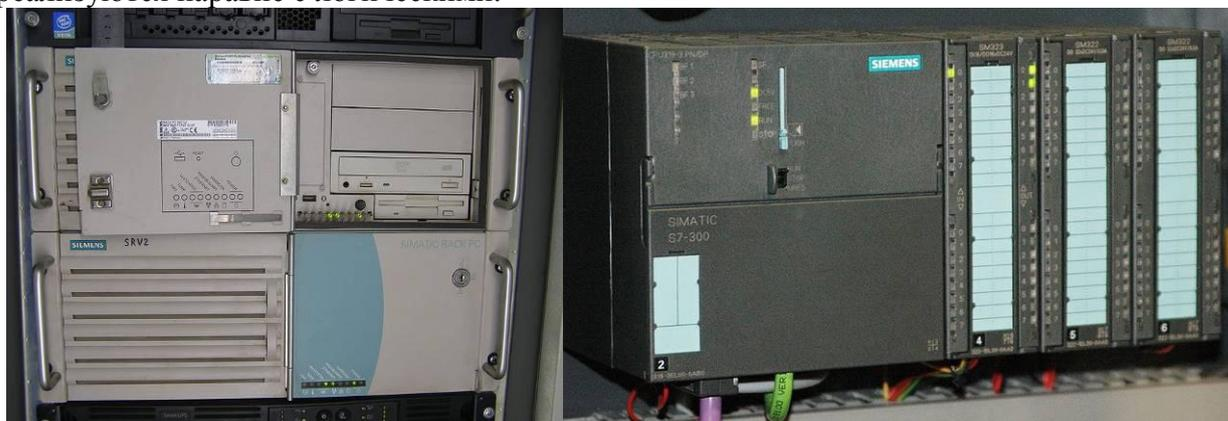
Рис. 6 – Промышленный компьютер (слева) и промышленный контроллер (справа)
