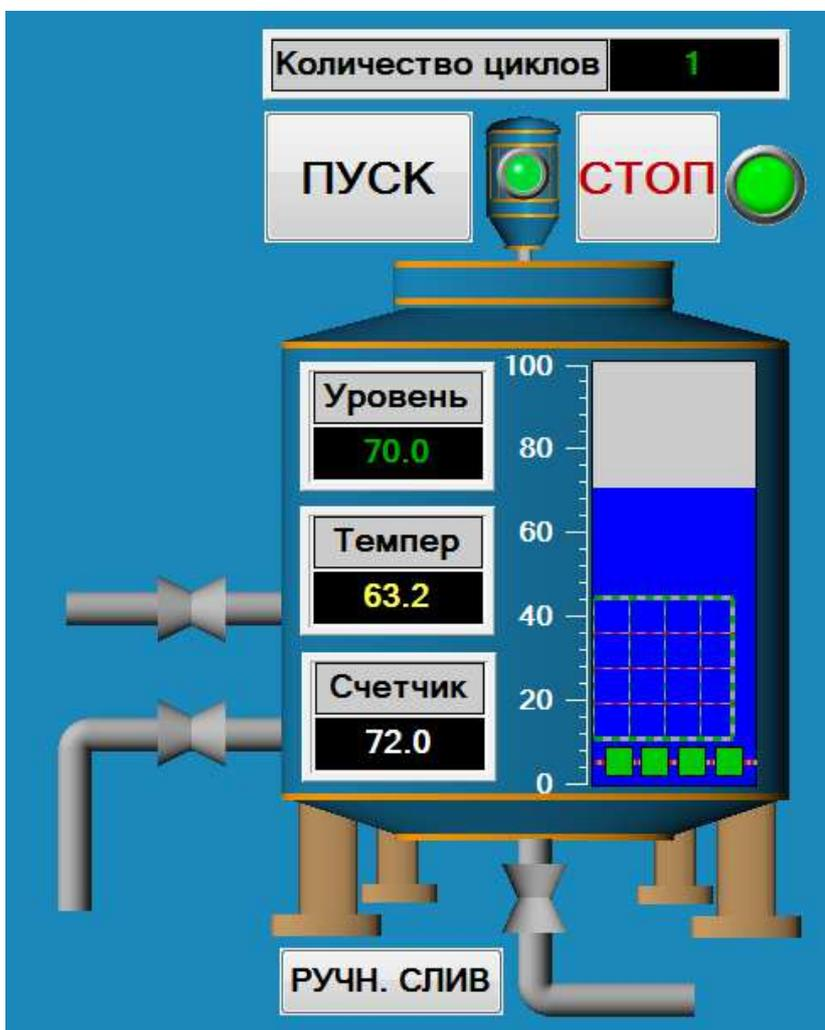
Рис. 2.18. Проект, запущенный на исполнение в профайлере
